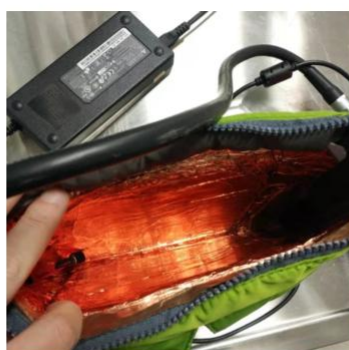
图 8b 测温探头和保温内衬
